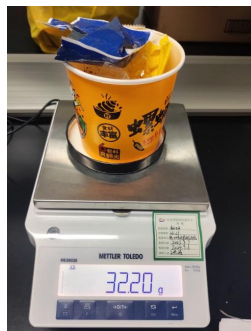
包装容器和其他包装材料的重量（材料包装还进行清洗烘干哦）
