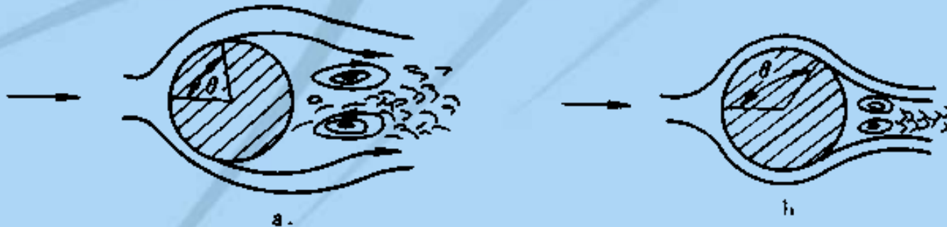
图5-3 绕球流动时的尾流
