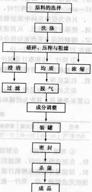
图 5-14 果蔬汁工艺流程图
