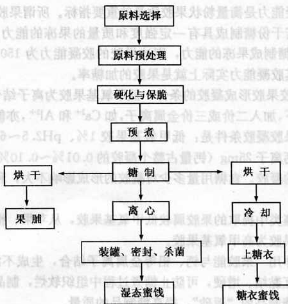
图 5-15 蜜饯类加工工艺流程图
