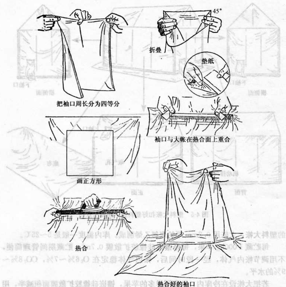
图 4-4 塑料大帐袖口热合制作过程示意图
